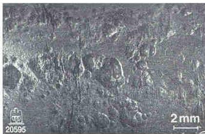
Bild 16. Niederzyklische Dehnungswechselrisse in einem Ölkühlerrohr (CuZn 20 Al), von Korrosionsgrübchen ausgehend.
